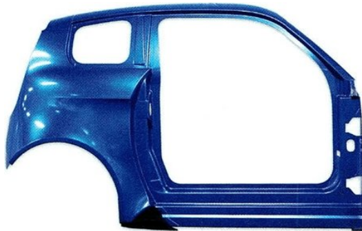
Bild 1. Seitenwand aus tiefgezogenen, zweischaligen Kunststoffplatten mit Verstärkungsrippen. Die Elastizität der ABS-PMMA-Platten verzeiht Bagatellschäden ohne bleibende Verformung (© Parat)
