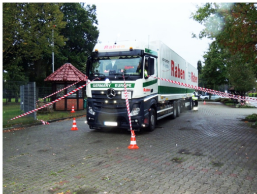
Das Absperrband macht den Bereich des toten Winkels sichtbar.
