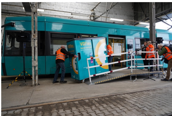
Über eine Rampe wird der ONO-Container mit wenigen Handgriffen in die Gütertram gerollt.
