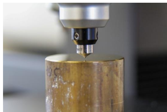
Prüfkopf mit Wolframkugel (Brinell).
