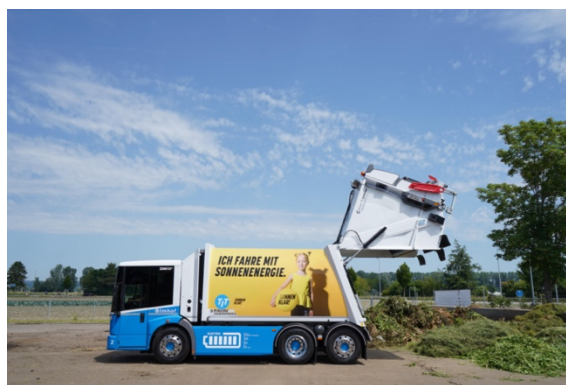
Die TIT Imhof Gruppe nutzt den Low Cab mit einer Batteriekapazität von 450 Kilowattstunden zur Abfallentsorgung.
