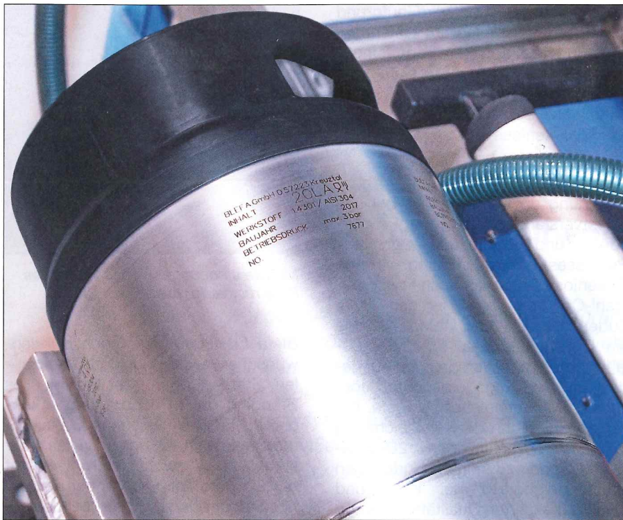
Das Ergebnis der Lasermarkierung (Foto: Mobil-Mark)
