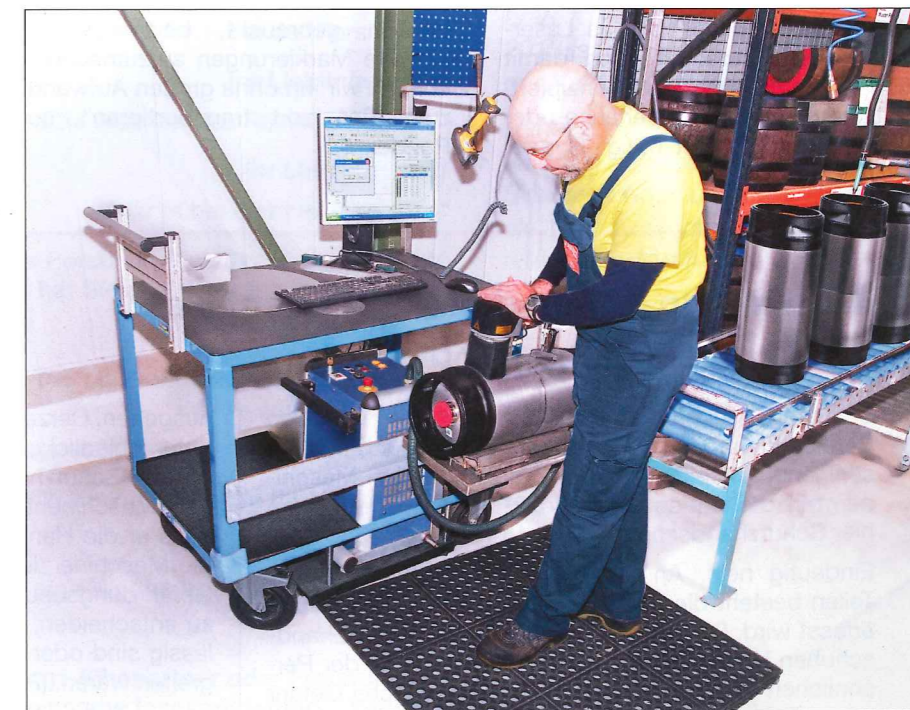
Das mobile Lasersystem im Einsatz (Foto: Mobil-Mark)
