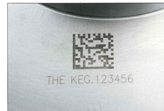
Mithilfe eindeutiger Codes wird jedes Fass rückverfolgbar. (Foto: Blefa)
