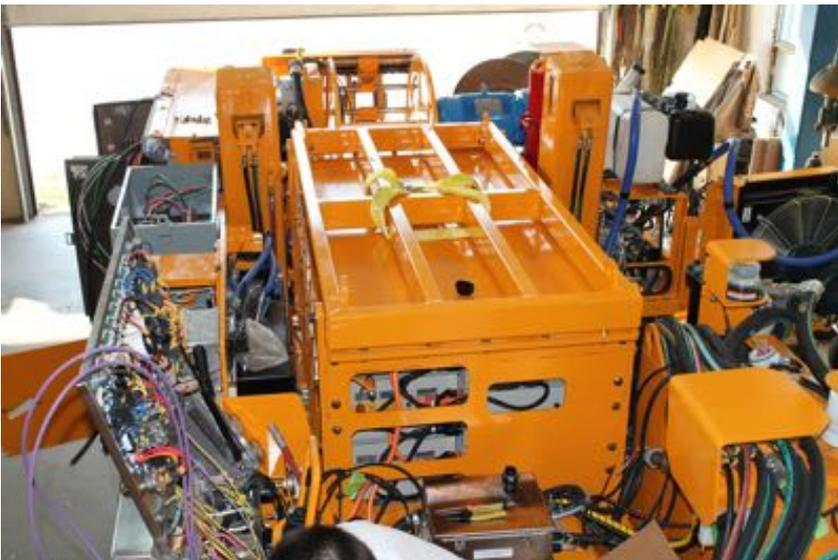
Stabil und sicher gelagert für den robusten Einsatz unter Tage: das AKASOL-Li-Ionen-Batteriesystem AKASYSTEM 15 AKM NMC NANO. (Foto: Medatech)
