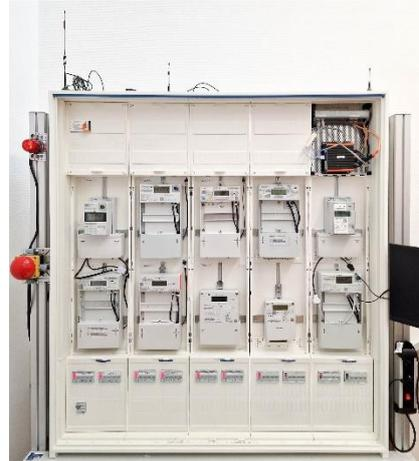
Im eigenen Labor in Wutha-Farnroda führt EFR mit dem SMGW Whitelist-Tests an verschiedenen Zählern durch und untersucht 1:n-Anbindungen. (Bild: EFR)
