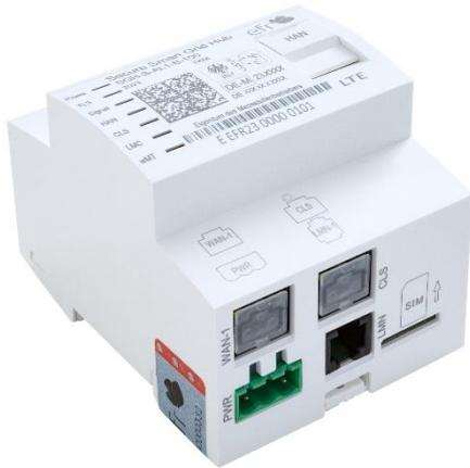
Das Smart Meter Gateway der EFR bietet neben einer Ethernet-WAN- und einer CLS-Schnittstelle (hier mit dem optionalen Fehlinstallationsschutz abgedeckt) auch eine HAN-Schnittstelle, welche die Einbindung in eine Smart-Home-Umgebung ermöglicht. (Bild: EFR; Fotografin: Maria Dorner)
