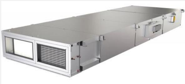
Das dezentrale Fassadenlüftungsgerät FVS *Eco<sub>2</sub>School* bezieht frische Luft direkt über eine wettergeschützte Fassadenöffnung und befördert verbrauchte Luft über dieselbe Öffnung nach draußen. Da im Gegensatz zu einer zentralen Lüftung kein Lüftungsnetz erforderlich ist, fallen die Druckverluste für den Lufttransport durch das Gebäude weg und die Geräte lassen sich leichter nachträglich installieren.
