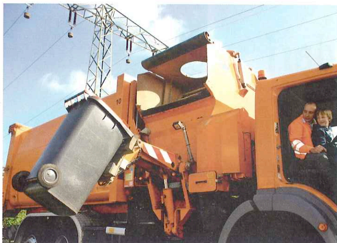
Mit Hilfe eines Identensystems wird die Anzahl der Leerungen je Behälter innerhalb eines Halbjahres festgehalten.
