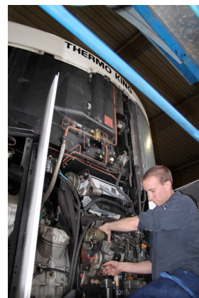
Kühlmaschinen-Wartung bei den Thermo King-Händlern
