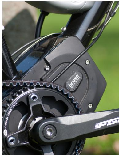
Das flitzbike „Traveller“ kombiniert Leistungsstärke mit Wartungsarmut: brose-Mittelmotor mit Riemenantrieb von Gates Carbon Drive.
